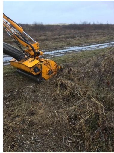
Figuur 10 Inzet van de zuigklepelmaaier langs de duinenrij op Schiermonnikoog (Foto's Jan Willem Zwart, Natuurmonumenten)
