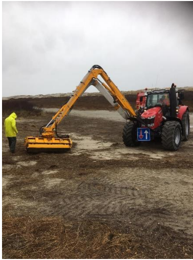
Figuur 10 Inzet van de zuigklepelmaaier langs de duinenrij op Schiermonnikoog (Foto's Jan Willem Zwart, Natuurmonumenten)
