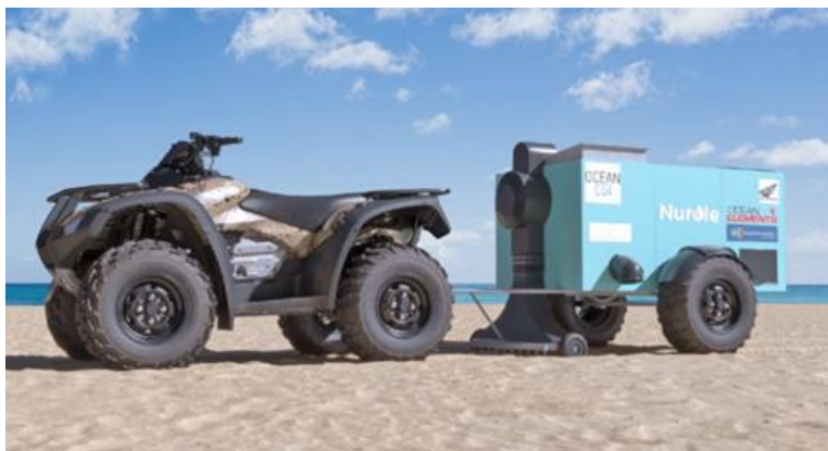
Figuur 9 Microplastic machine van Nurdle.org, hier uitgerust met de 'stofzuigermond' om plastics van het vlakke zand op te zuigen ( https://nurdle.org.uk/microplastic-machine/ )
