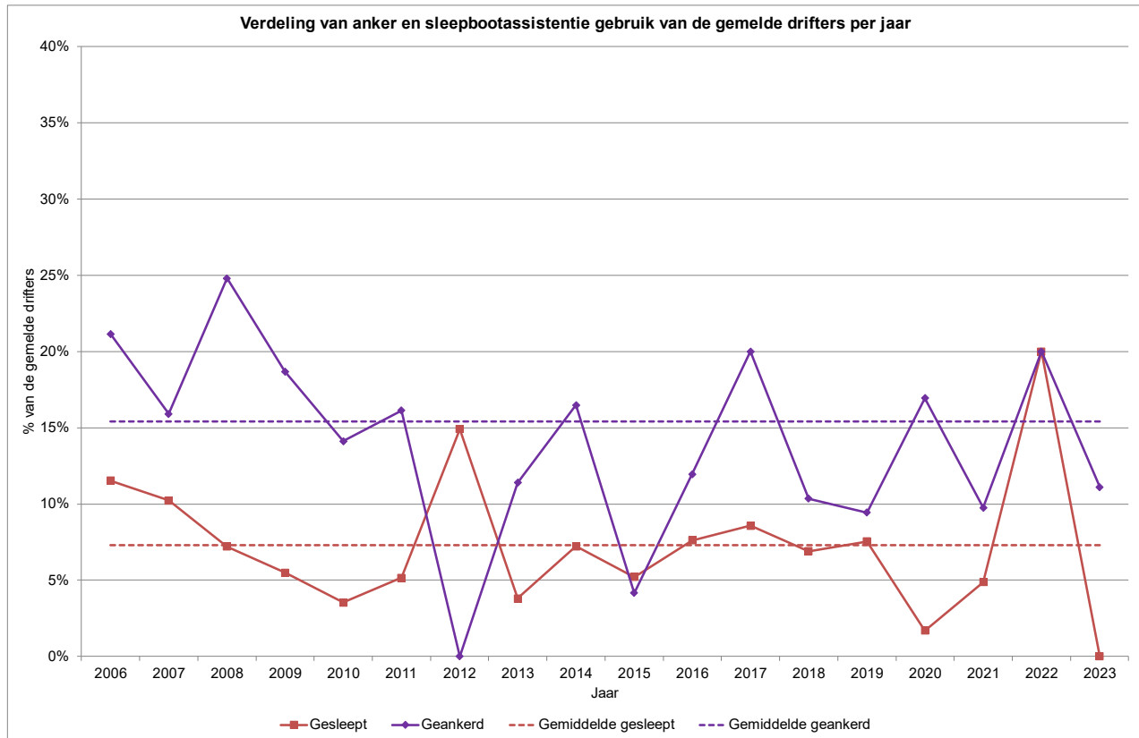
Figuur 8-4 Verdeling van anker en sleepbootassistentie gebruik door schepen die zich als onmanoeuvrerbaar hebben gemeld bij de Kustwacht over de jaren
