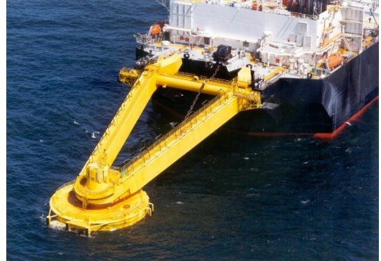
Figuur 4-3: CALM boei met yoke constructie (proven technology)
