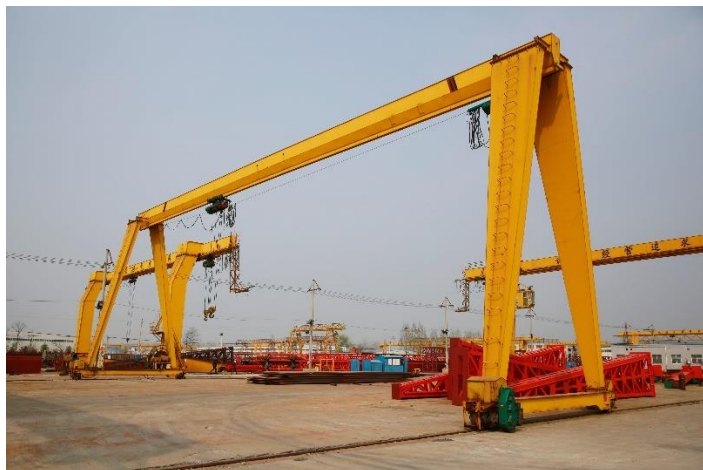
Figuur 5-5: Voorbeeld gantry kraan
