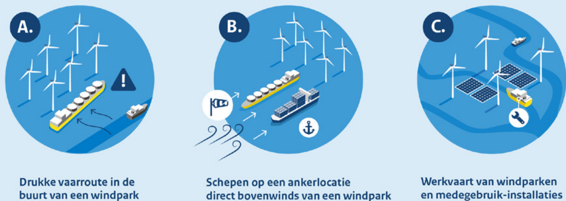
Figuur 2: Overzicht van de drie risicoverhogende situaties als gevolg van de aanleg van windparken op zee voor de scheepvaartveiligheid.
