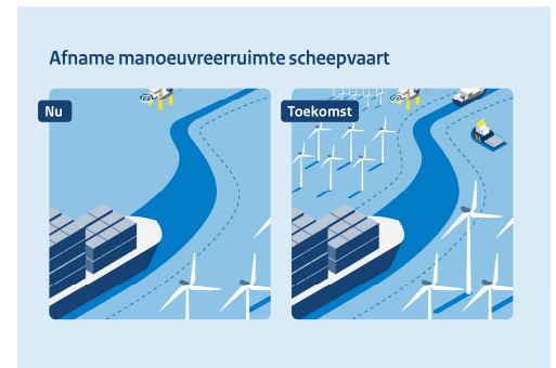
Figuur 7: Schematische weergave van de invloed van windparken op zee op de manoeuvreerruimte van scheepvaart.
