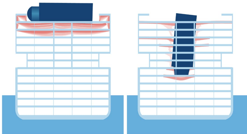
Figuur 16: Visuele weergave van het gevolg van het horizontaal (links) of verticaal (rechts) vallen van een nacelle op een schip [39].
